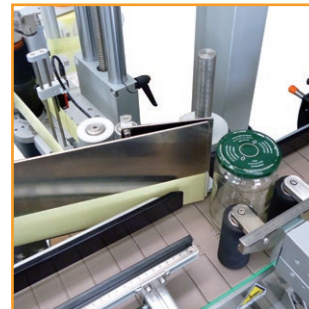
Double labelling unit for front & back application Doppia etichettatrice per applicazione fronte & retro
