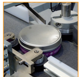
Three rollers customized rotating units Unità di rotazione a tre rulli personalizzate
